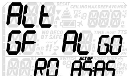
Der Quad 2 erlaubt es, ein alternatives Set von Gradient Factors einzurichten, wenn Sie in einem Notfall Ihre Dekompressionsverpflichtungen kürzen müssen. Das Set der alternativ Gradient Factors kann nicht konservativer (d. h. tiefer) sein als das Set der GF-Werte. Der Standardwert ist **RO (85/85)**.
