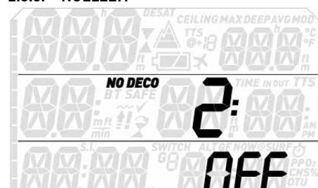
Wenn diese Funktion **ON** ist, wird eine Warnung Sie darauf hinweisen, dass in 2 Minuten die Nullzeit abläuft.
