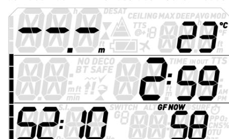
Wenn Sie vor Ablauf des Countdowns wieder abtauchen, wird die Messung der Tauchzeit fortgesetzt, einschließlich der an der Oberfläche verbrachten Zeit. Wenn Sie innerhalb des Countdowns nicht wieder abtauchen, betrachtet der Quad 2 den Tauchgang als beendet, speichert die Daten im Logbuch und schaltet in den Modus **POST DIVE**.
