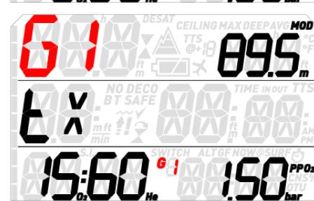
Der Quad 2 erlaubt es, bis zu 5 Gase einzurichten, für die Sie zusätzlich zum Sauerstoffanteil auch den Heliumanteil in Prozent einstellen können. Alles ist gleich wie für Multigas-Nitroxtauchgänge aber zusätzlich mit OTUs (Oxygen Toxicity Units) in der Reihenfolge der Datenfelder in der rechten unteren Ecke.
