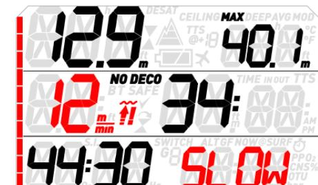
Die Warnmeldungen dauern an, bis die Aufstiegsgeschwindigkeit wieder auf oder unter das Limit sinkt. Die Limits hängen von der aktuellen Tiefe ab:
