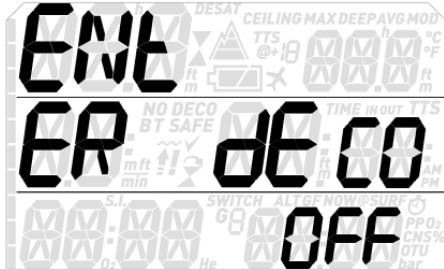
Wenn diese Funktion **ON** ist, wird eine Warnung Sie darauf hinweisen, dass der Quad 2 einen obligatorischen Dekostopp errechnet hat.
