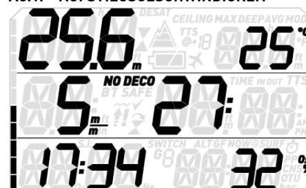
Sobald der Quad 2 feststellt, dass die Tiefe abnimmt, aktiviert das Gerät den Kontrollalgorithmus zur Überwachung der Aufstiegsgeschwindigkeit und zeigt den errechneten Wert numerisch und grafisch an.
