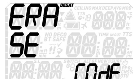
Der Quad 2 gibt Ihnen die Möglichkeit, die Sättigungsdaten zu löschen. Alle Daten über die Gewebesättigung aus vorangegangenen Tauchgängen werden dabei auf null zurückgesetzt und der Computer berechnet den nächsten Tauchgang nicht mehr als Wiederholungstauchgang. Das ist nützlich, wenn der Computer an einen Taucher ausgeliehen wird, der innerhalb der letzten 24 Stunden nicht getaucht ist.
