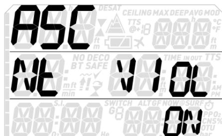
Wenn die Aufstiegsgeschwindigkeit 120 % des erlaubten Werts über einen Tiefenwechsel von mehr als 20 m beträgt, blockiert der Quad 2 sich aufgrund von der möglichen Bildung von schädlichen Blasen für 48 Stunden, um zu verhindern, dass wieder getaucht wird. In diesem Menü können Sie die Funktion der Sperrung bei unkontrolliertem Aufstieg ausschalten.
