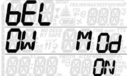
Wenn diese Funktion **ON** ist, erlaubt der Quad 2 einen Gaswechsel auf einer Tiefe, die tiefer als die MOD dieses Gases ist (was sofort einen MOD-Alarm auslöst).
