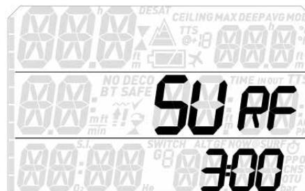
In diesem Menü kann man die Dauer des Intervalls zwischen dem Erreichen der Oberfläche und dem Abschluss des Tauchgangs durch den Tauchcomputer einstellen. Während dieses Intervalls können Sie wieder abtauchen und den Tauchgang fortsetzen. In diesem Menü können Sie das standardmäßige 3-Minuten-Intervall auf einen beliebigen Wert zwischen 1 Minute und 45 Minuten ändern.
