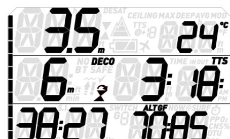
Wird in diesem Fall nach Erreichen der Oberfläche versucht, einen Wiederholungstauchgang durchzuführen, arbeitet der Quad 2 nur als Tiefenmesser und Timer (Tiefenmessermodus) und das Symbol eines Dekoverstoßes wird angezeigt (☒).
