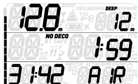
Wenn Sie über die Nullzeit hinaus auf Tiefe bleiben, werden zunehmend mehr **DECO**stopps angezeigt. **DECO**stopps sind **PFLICHTSTOPPS**. Wenn Sie sich einer Stopptiefe nähern, wird die Dauer des Stopps graduell reduziert. Die Dauer wird immer in Minuten angezeigt und wird in Funktion des Druckabfalls berechnet, der beim Stopp erreicht wird. Je weiter Sie daher von der exakten Tiefe des Stopps entfernt sind, desto langsamer wird die fuer den Dekostopp notwendige Zeit ablaufen.
