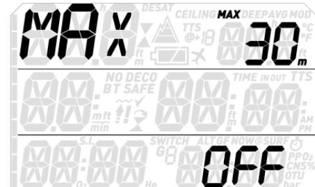
Der Quad 2 ermöglicht es Ihnen, einen Alarm auf einer Tiefe einzurichten, die unabhängig von der MOD ist. Der Standardwert ist **OFF**. Mit **TR-SP** oder **BR-SP** können Sie die Tiefe in Schritten von 1 m zwischen 10 m und bis knapp auf die MOD einrichten. Bei Erreichen der festgelegten Tiefe wird ein Alarm ausgelöst, der sich ähnlich verhält wie der **MOD**-Alarm (Abschnitt 7.3.2). Drücken Sie eine beliebige Taste zur Bestätigung
