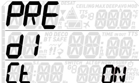
Wenn diese Funktion **ON** ist, wird der Quad 2 alle Gase zusammen mit den durchgeführten Gaswechseln auf der MOD jedes Gases in der Dekompressionsberechnung einbeziehen. Wenn diese Funktion **OFF** ist, berücksichtigt die Dekompressionsberechnung nur das derzeit geatmete Gas. Siehe Abschnitt 10 für weitere Informationen über die Funktion **PRÄDIKTIV**.
